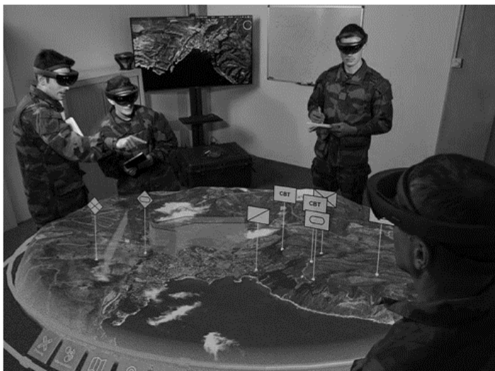
1. ábra: Holografikus, kiterjesztett valóság küldetés-előkészítő műveleti asztal 11
