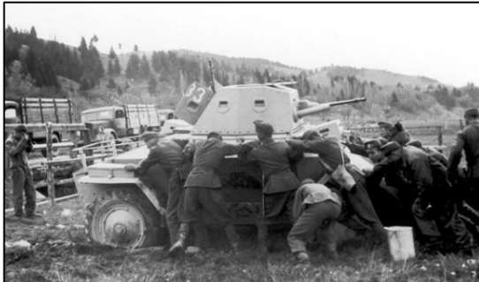
13. kép. Az elakadt Csaba tornyán jól látszik a hátul kinyitott ablak és abban a légvédelmi célokra rendszeresített 8 mm-es golyószóró csöve
